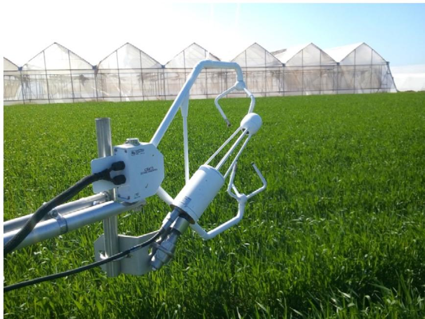
Figura 1. Sistema de Covarianza de Vórtices instalado en el cultivo de trigo durante el ciclo 2016-2017.
