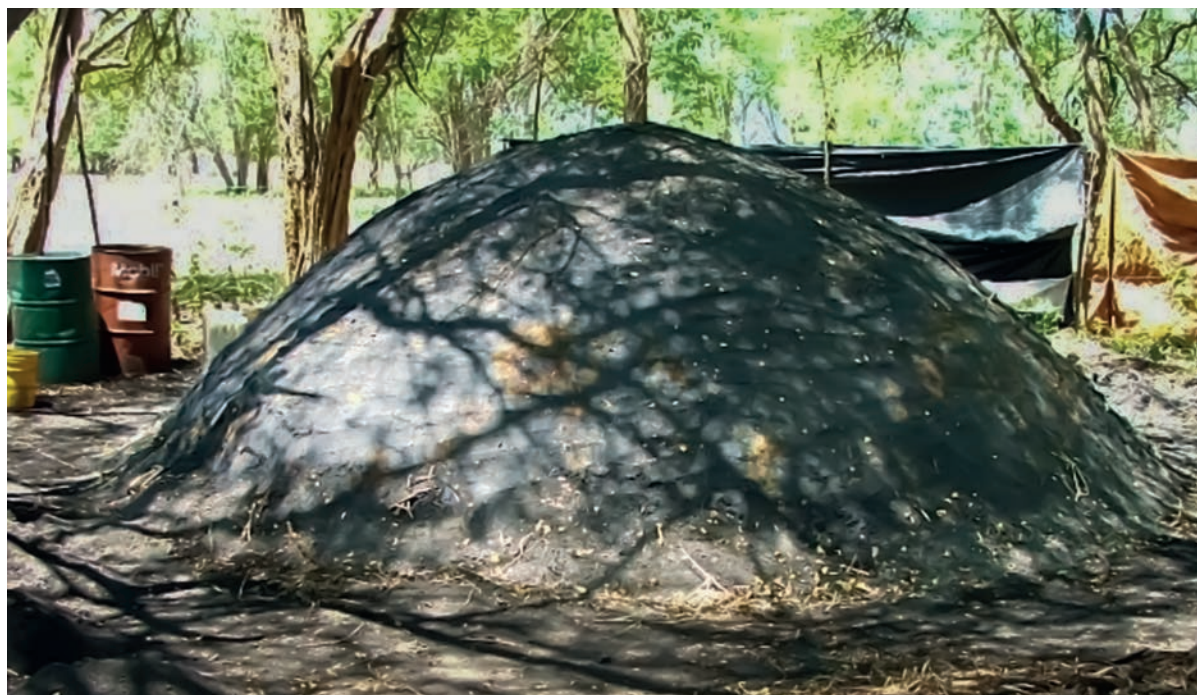
Figura 4. Horno tradicional en la localidad El Tintillo, para la elaboración de carbón de tinto. Foto: Humberto Hernández-Trejo.
